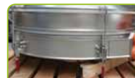
Скоростные зажимы для быстрой замены сит
