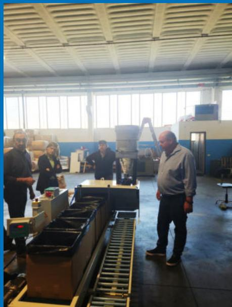
**Назначение упаковочной линии** – обеспечить точный вес порошка в коробке и освободить оператора от необходимости постоянно присутствовать при просеивании и наполнении емкостей порошком. Таким образом оператор может выполнять другие задачи: поднимать и запечатывать коробки, помещать их на паллеты и пр.
