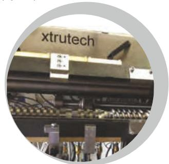
Двухшнековые экструдеры серии XTS имеют оптимальную геометрию большого объема D/d 1.8 для обработки порошковых покрытий.
