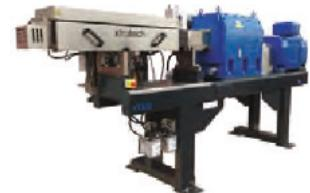
Xtrutech — первый производитель, разработавший вставки водяного охлаждения внутри баррелей:
