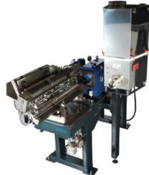
Xtrutech — первая компания, которая стала использовать двигатели Siemens переменного тока с водяным охлаждением для экструдеров в области порошковых покрытий:
